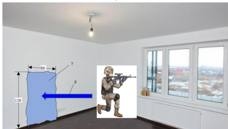
Рисунок 2.14 – Пророблення проходу у залізобетонних стінах:
