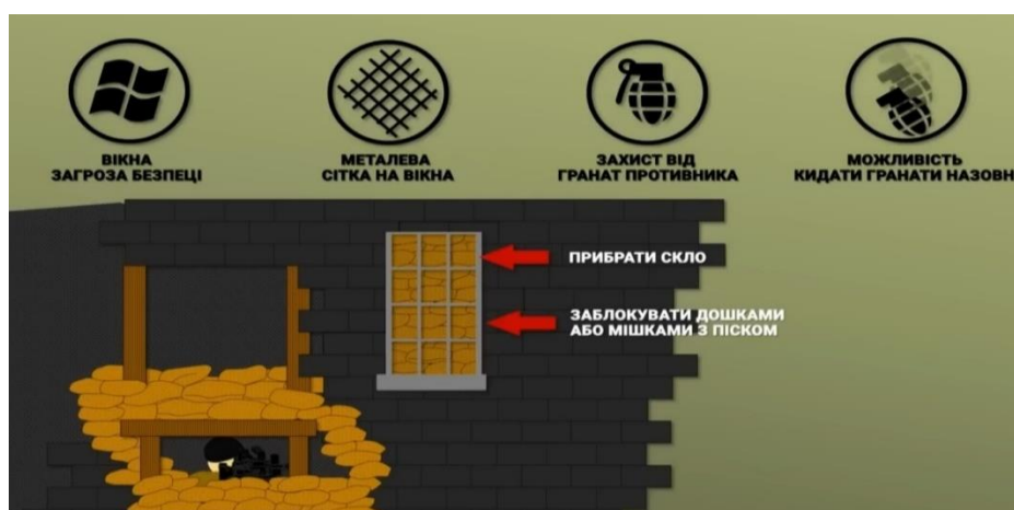
Рисунок 2.11 – Способи блокування підвалів та перших поверхів
