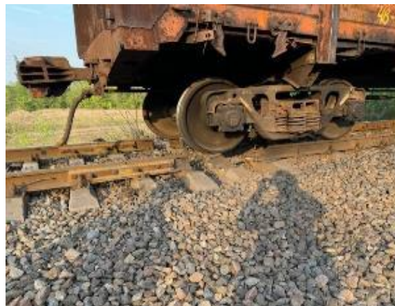
Рисунок 1.11 – Улаштування загороджень на залізничних коліях
