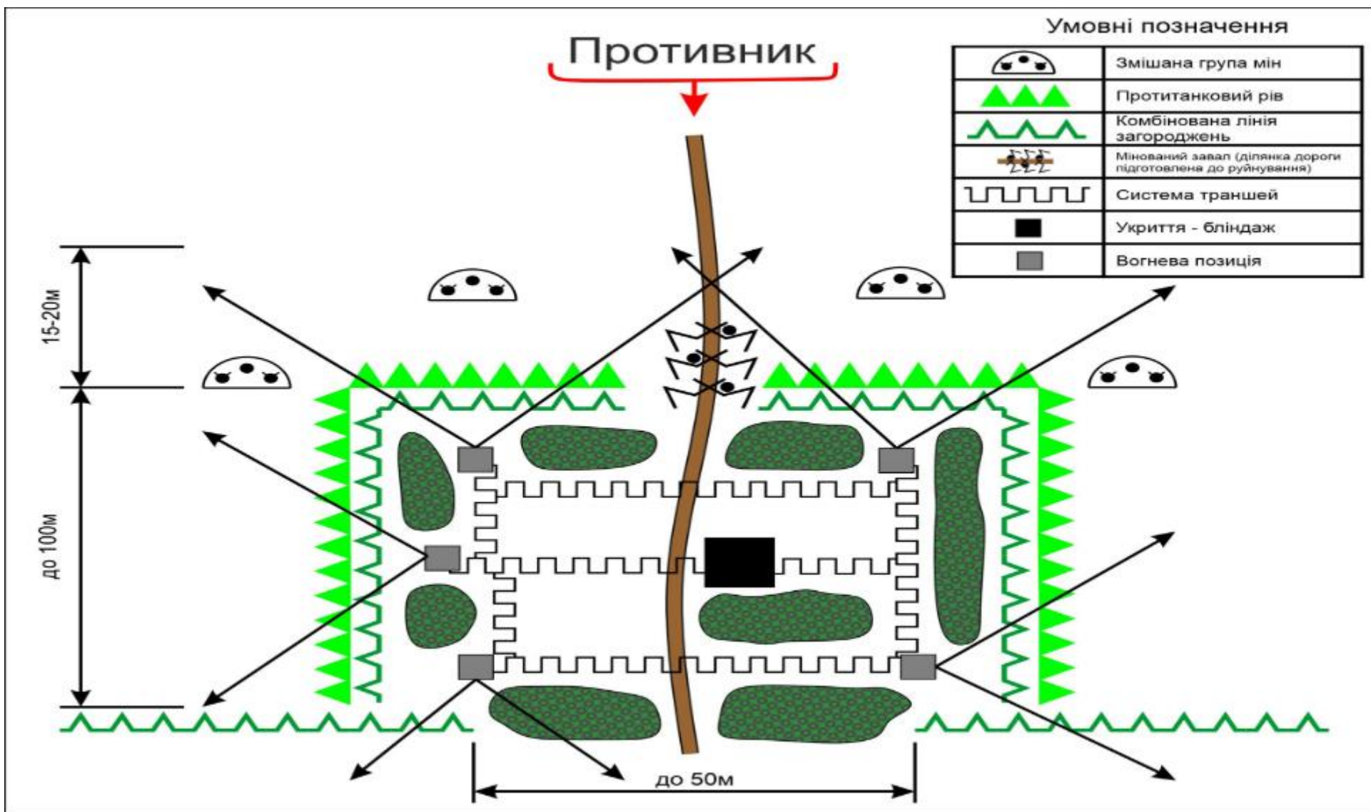
Рисунок 26 – Комбіновані загородження для прикриття окремих позицій в обороні на дорожньому напрямку (варіант)
