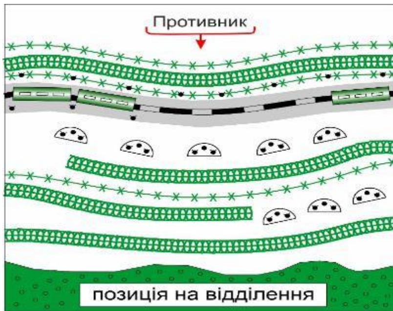
Рисунок 28 – Улаштування комбінованих загороджень з використанням залізничної дороги
