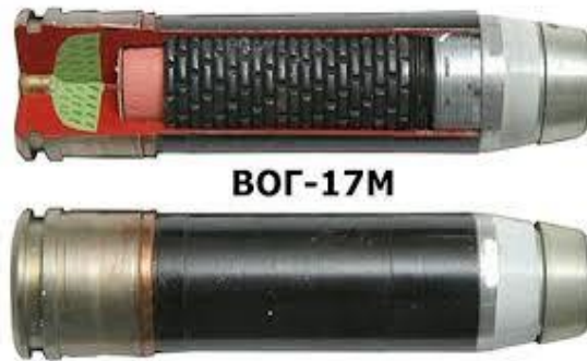
Рисунок 11 – загальний вигляд пострілу зі скалковою гранатою до АГС-17 ВОГ-17М.
