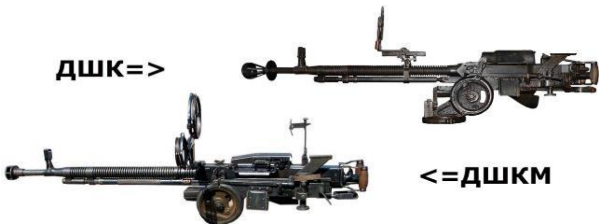
Рисунок 10 – 12,7-мм кулемет зразка 1938 року ДШК і 12,7-мм кулемет ДШКМ зразка 1938/46 років.
