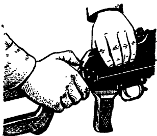
Рис. 4. Открывание крышки ствольной коробки
