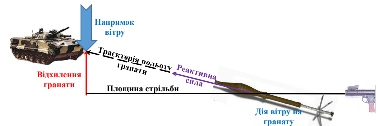
Рисунок 9 – дія реактивної сили на гранату при наявності бічного вітру.
