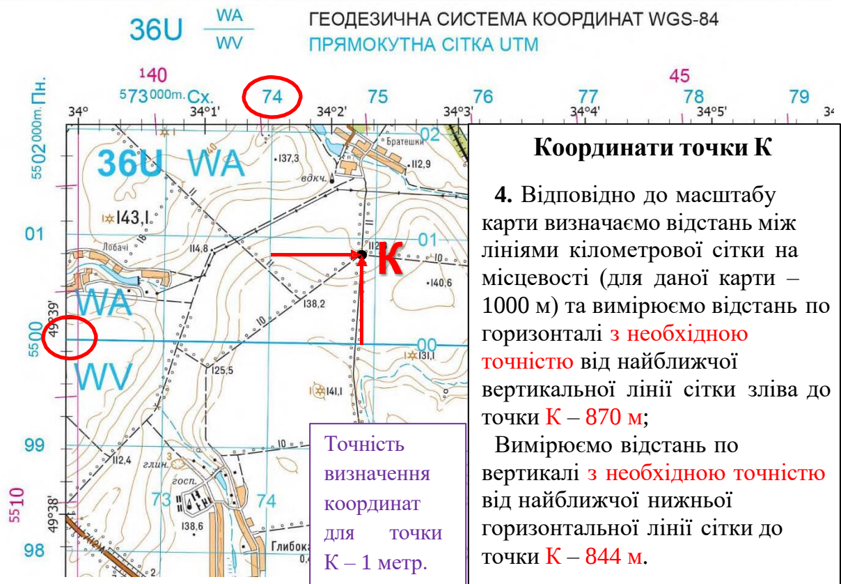
Рисунок 77 – Вимірювання відстаней від горизонтальної і вертикальної ліній сітки
