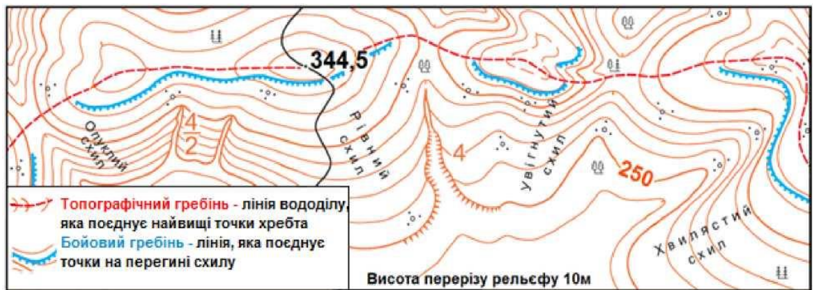
Рисунок 27 – Визначення різновидів схилу, топографічного і бойового гребенів за зображенням горизонталей на карті
