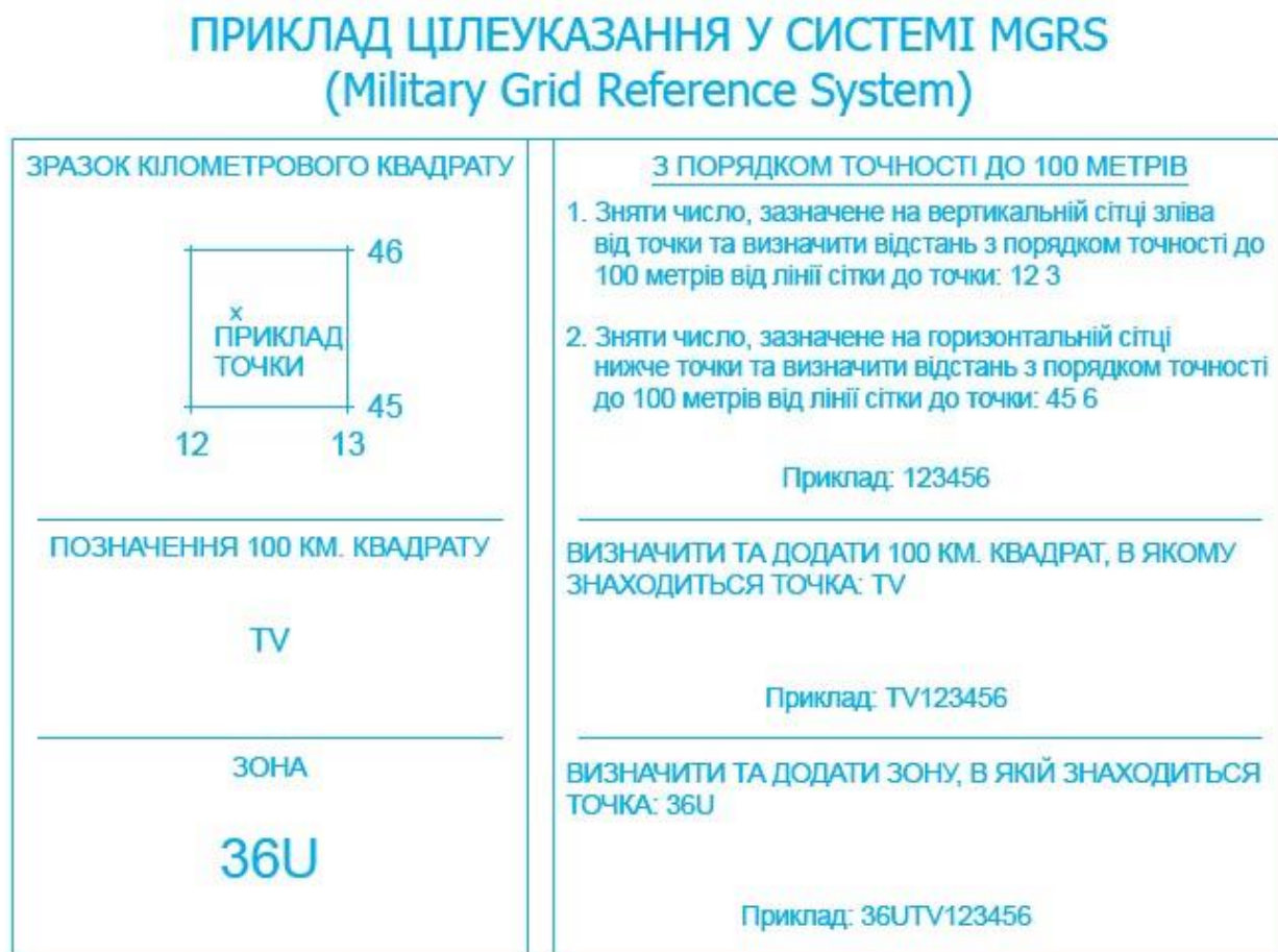
Рисунок 71 – Пояснення на топографічних картах щодо практичного використання системи цілевказання MGRS (з точністю до 100 м)
