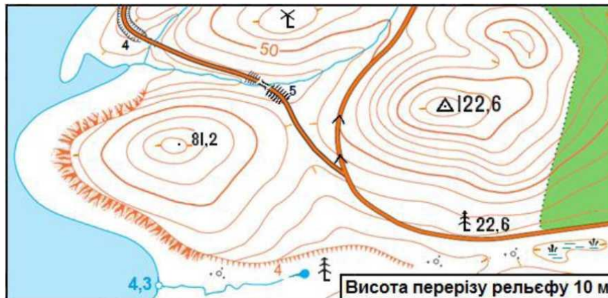
Рисунок 23 – Визначення ознак зниження схилу на карті
