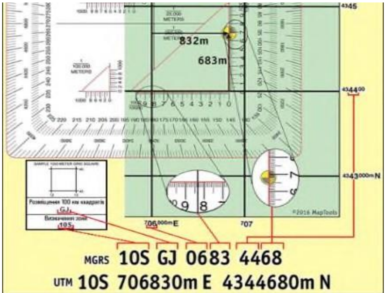
Рисунок 72 – Приклад визначення координат за кілометровою сіткою UTM у системі цілевказання MGRS
