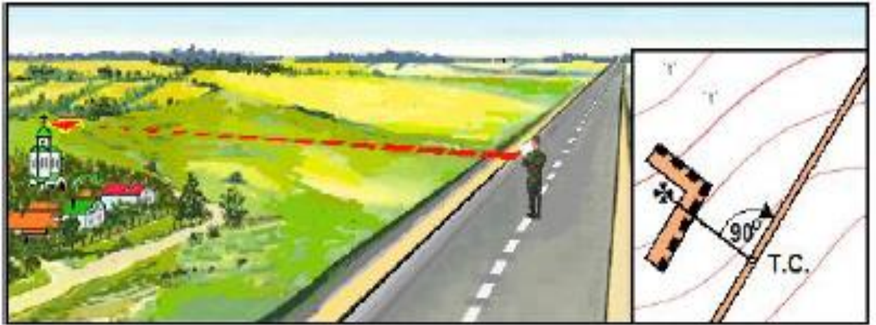
Рисунок 34 – Визначення точки стояння способом перпендикуляра
