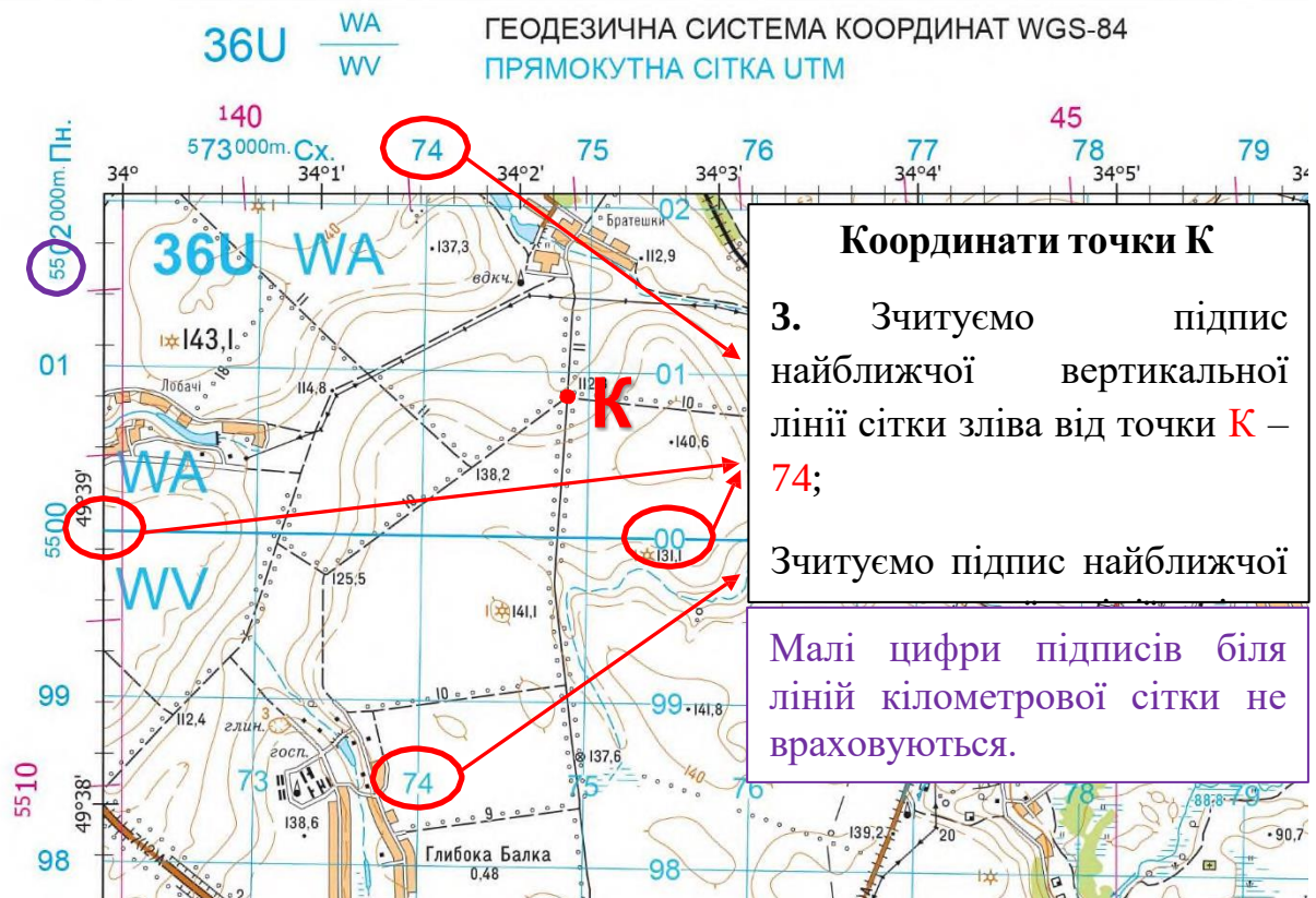
Рисунок 76 – Зчитування значень найближчих горизонтальних і вертикальних ліній сітки
