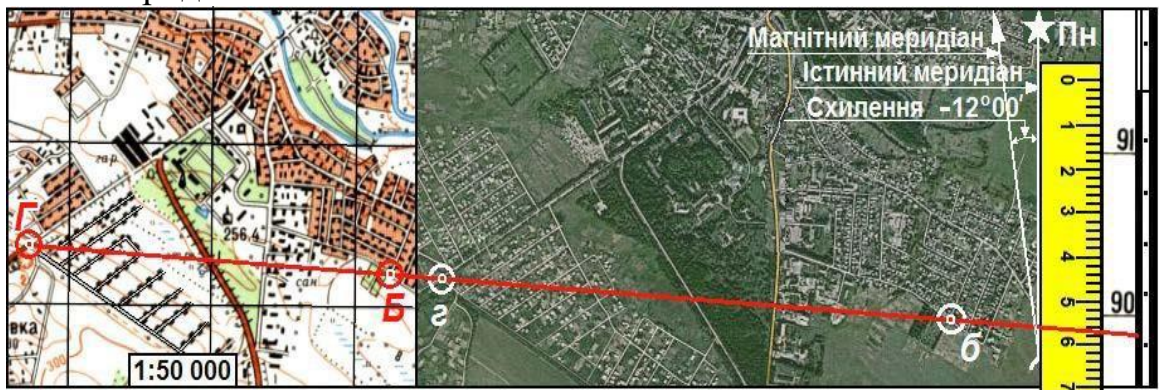
Рисунок 15 – Нанесення істинного і магнітного меридіанів на аерознімок
