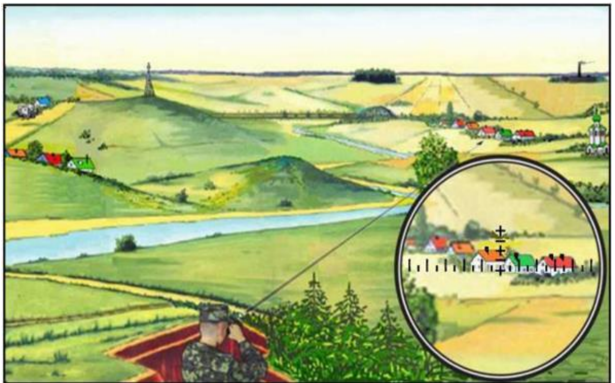
Рисунок 47 – Визначення відстані за шкалою бінокля
