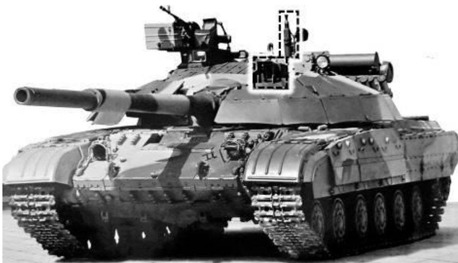
Рисунок 130 – танк Т-64БМ “Булат” з виділеним розташуванням захисного ковпака прицілу та стійки датчика вітру.
