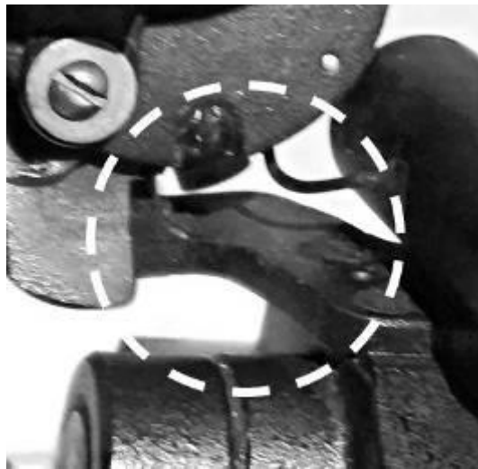
Рисунок Д8.15 – місце вигину монтажної пластины прицілу ПГО-7В6М.
