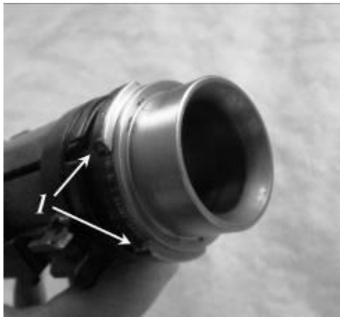
Рисунок 16 – з'єднання труби і патрубка РПГ-7В.
