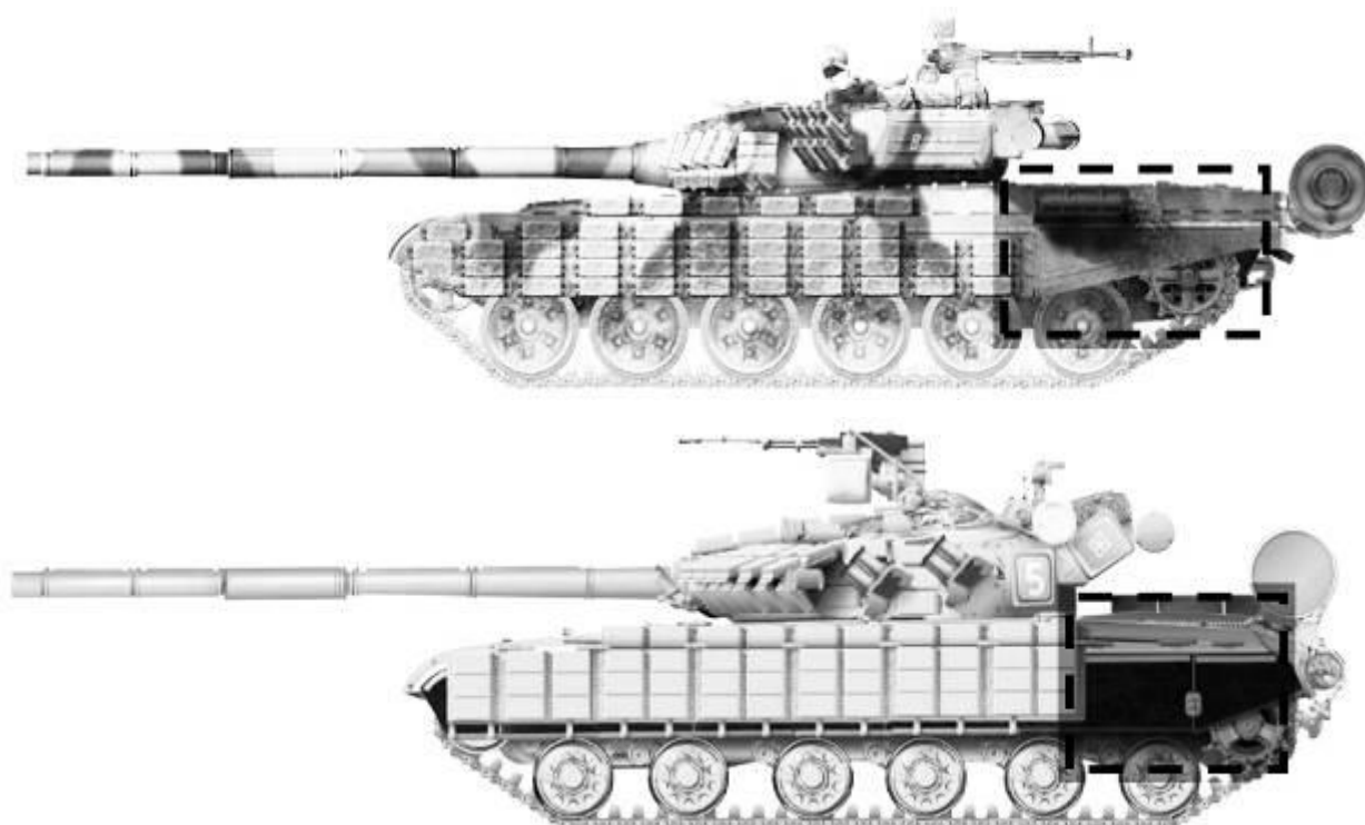
Рисунок 122 – порівняння між розмірами моторно-трансмійного відділення танків Т-72Б та Т-64БМ.
