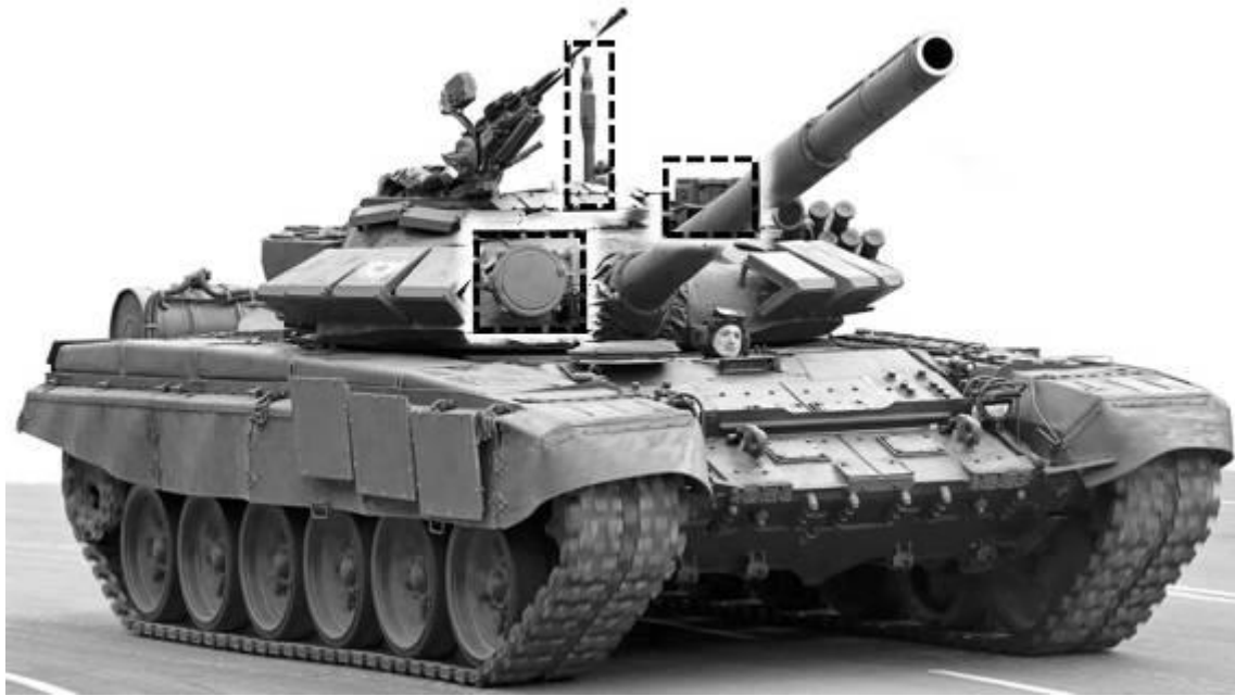
Рисунок 125 – танк Т-72БА з виділеним розташуванням інфрачервоного прожектора, захисного ковпака прицілу та стійки датчика вітру.
