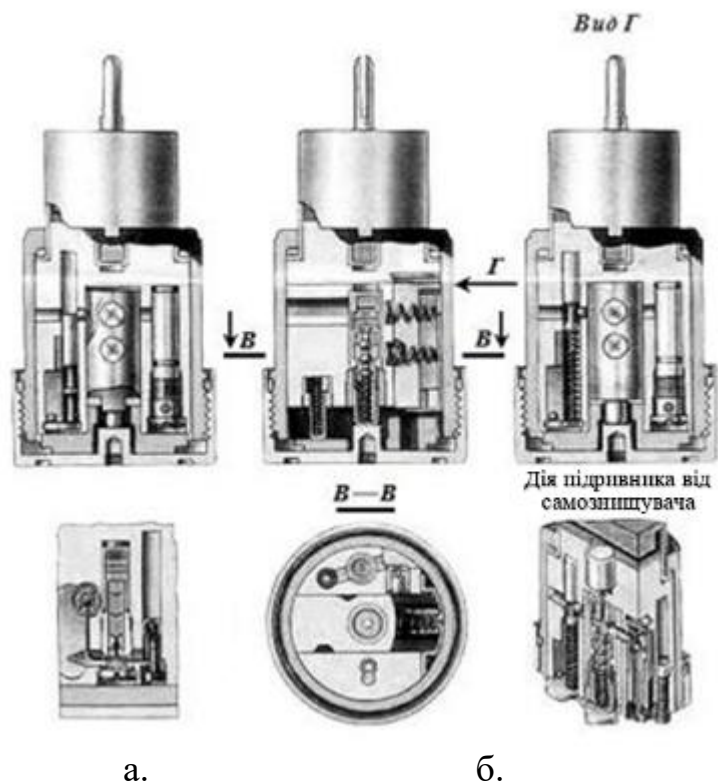
Рисунок 56 – положення деталей донного підричника при пострілі та після нього.
