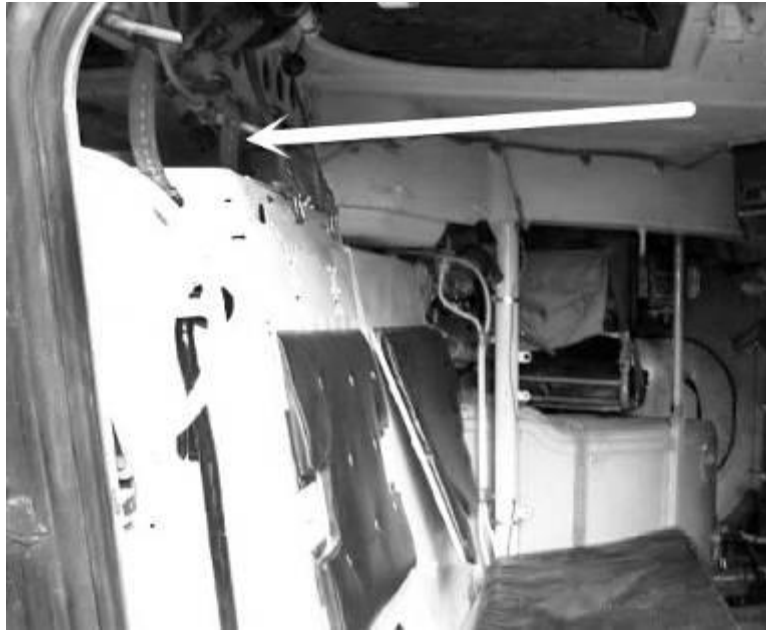
Рисунок 74 – місце кріплення гранатомета в бойвих машинах піхоти.
