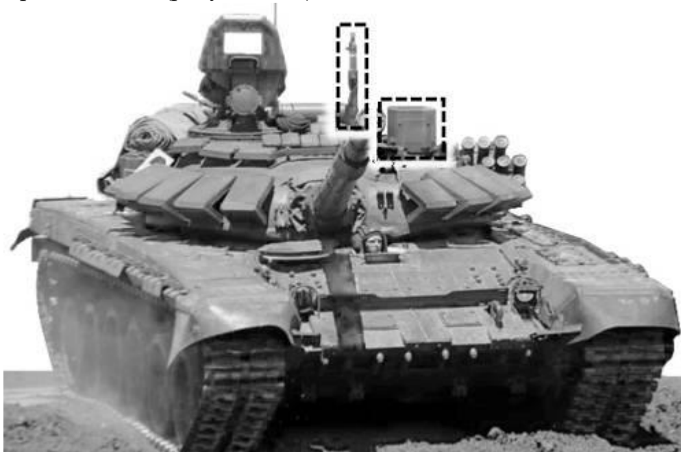
Рисунок 126 – танк Т-72БЗ з виділеним розташуванням захисного ковпака прицілу та стійки датчика вітру.
