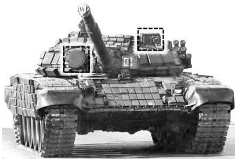
Рисунок 124 – танк Т-72Б з виділеним розташуванням інфрачервоного прожектора та захисного ковпака прицілу.
