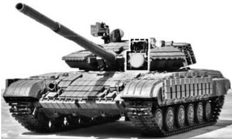
Рисунок 129 – танк Т-64БМ з виділеним розташуванням інфрачервоного прожектора та захисного ковпака прицілу.
