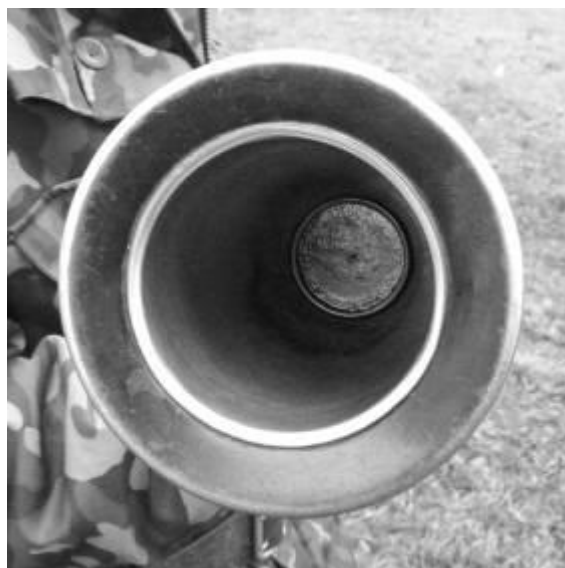
Рисунок Д5.2 – правильне положення дна від пеналу для порохового заряду в розрубі гранатомета.
