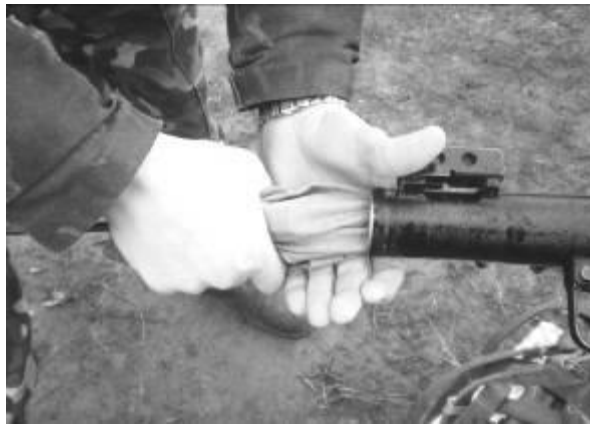
Рисунок 71 – введення шомполу в канал ствола гранатомету.
