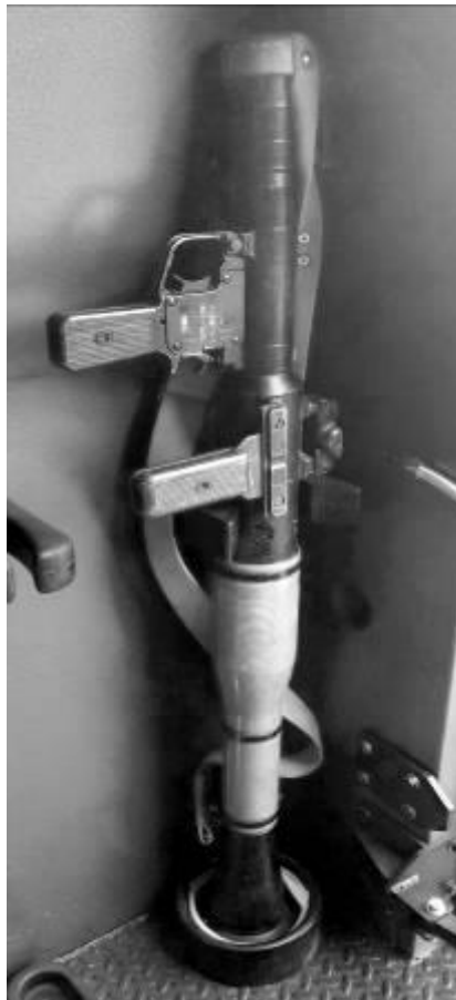
Рисунок 73 – місце кріплення гранатомета в машині “Козак-2М”.
