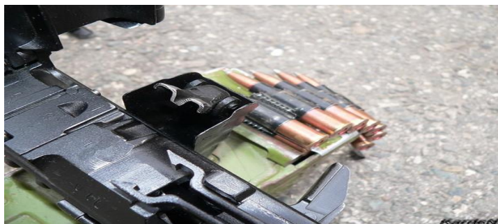
Рисунок 16 – приєднання коробки з патронною стрічкою до кулемета.
