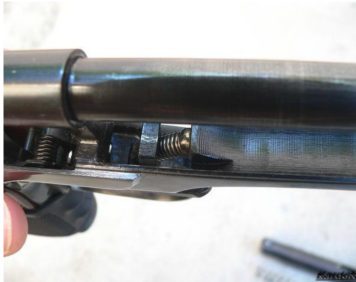
Рисунок 28 – надягання газового регулятора на газову комору.
