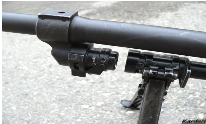
Рисунок 14 – суміщення патрубку газової комори з трубкою газового поршня.
