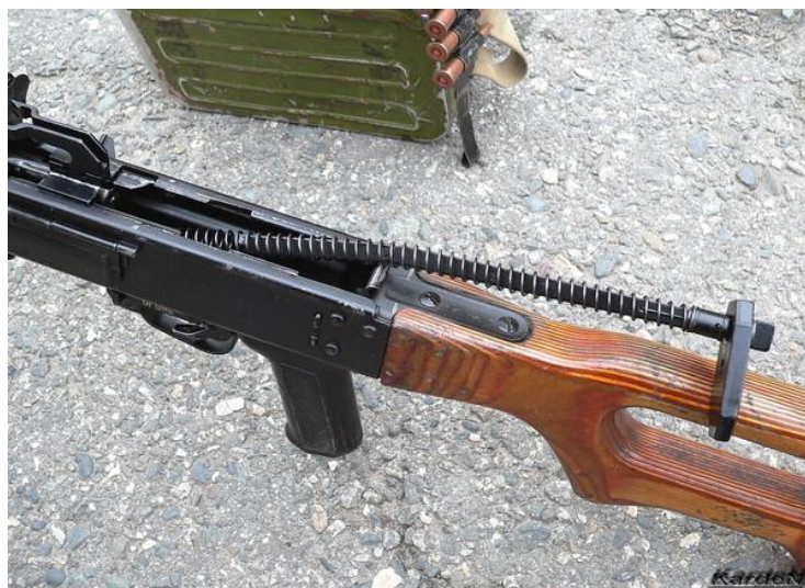
Рисунок 7 – від'єднання зворотно-бойової пружини з напрямним стрижнем.
