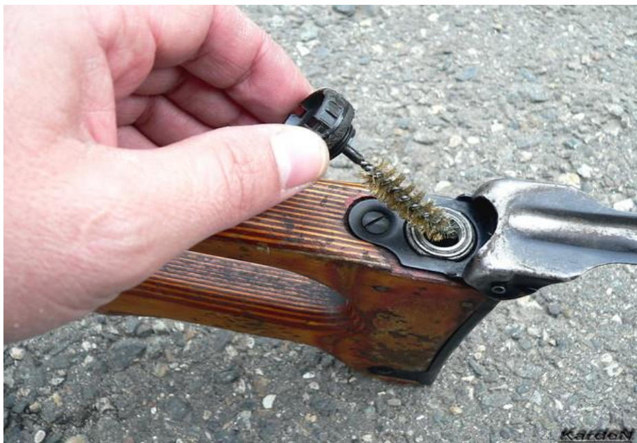
Рисунок 77 – вмонтована в приклад кулеметів КК, ККМ, ККС, ККМС масничка з кришкою та йоржиком.
