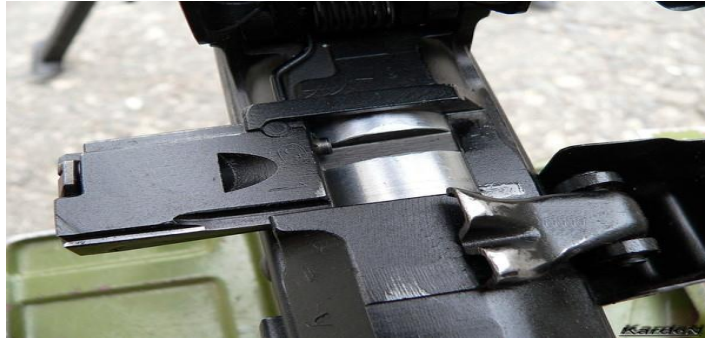
Рисунок 11 – зрушення замикача ствола ліворуч до упора.
