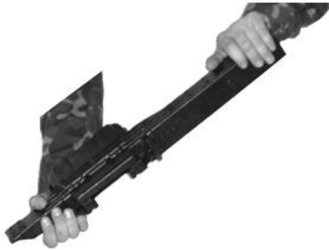
Рисунок 2.2 – відокремлення кришки від ствольної коробки.
