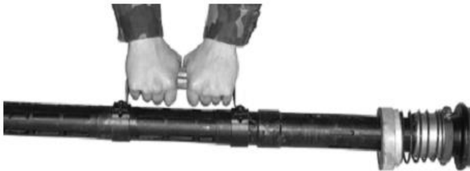
Рисунок 2.1 – відокремлення ствола від ствольної коробки.
