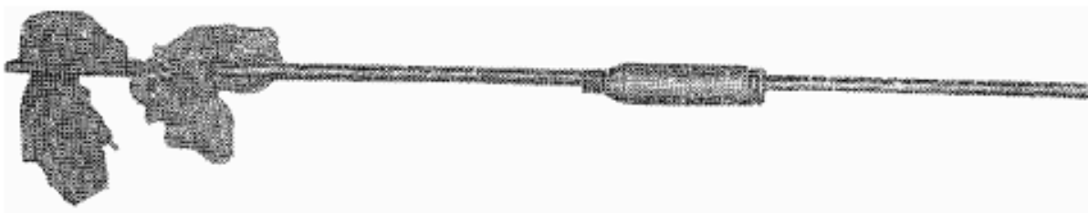
Рисунок 6.1 – шомпол, підготовлений для чищення каналу ствола.
